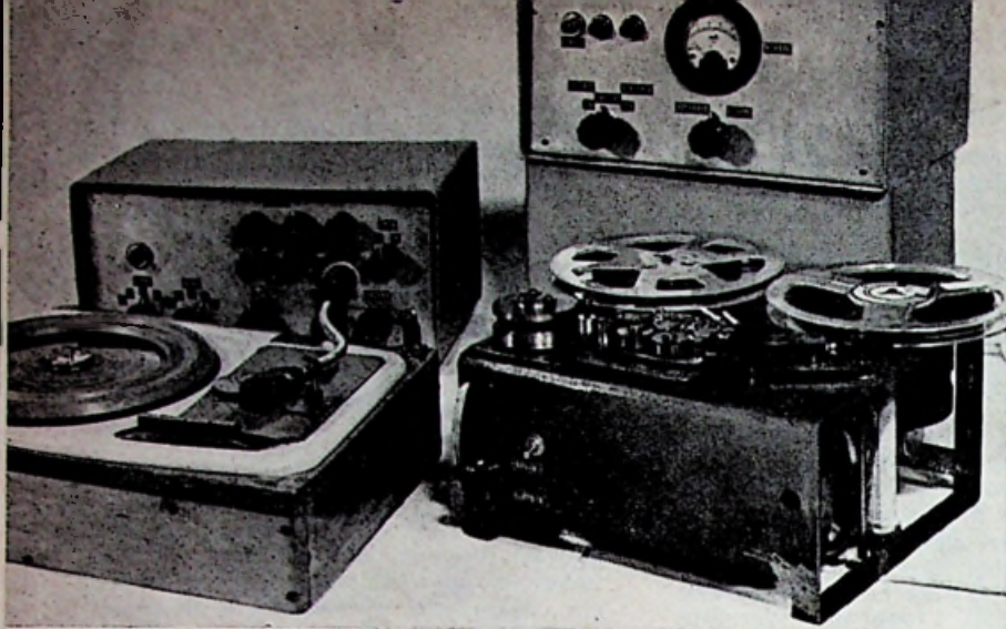
Afb. 3 - Rechts de magnetofoon en het elektronische deel. Links de draaitafel en voorversterker plus p.u. versterker.
