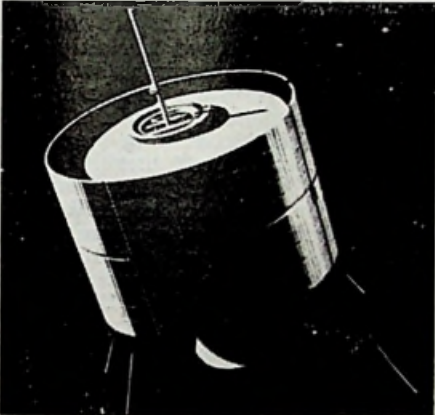
Afb. 3 - DE SATELLIET „EARLY BIRD”, de HS 303, waarvan de ommanteling met 6000 zonnecellen is bedekt.
